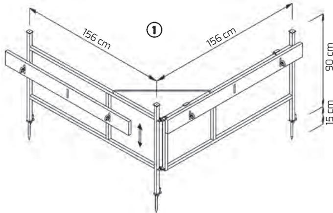
Durch die flexiblen Halterungen können die Nagelbretter vertikal und horizontal befestigt werden.
