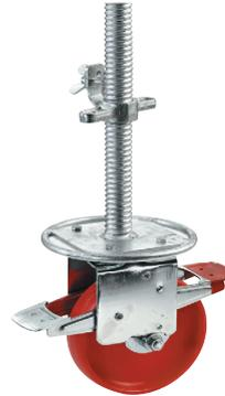
Die 11,9 kN Fahrrolle, Ø 200 mm, kann in allen RapidTech Aluminium Fahrgerüsten, unabhängig von der Aufbauhöhe, verwendet werden. Der an der Spindelmutter angebrachte Außenring erleichtert das Auf- und Abspindeln wesentlich und verhindert Verletzungen an Kanten.
