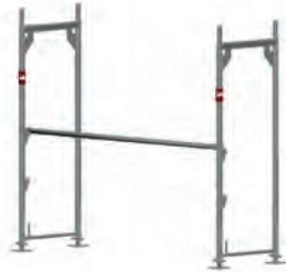
Vertikalrahmen aufstecken und mit Geländerholm sichern
